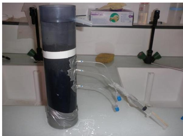
Figure 3: Système Rhizon® installé sur une carotte de sédiments
