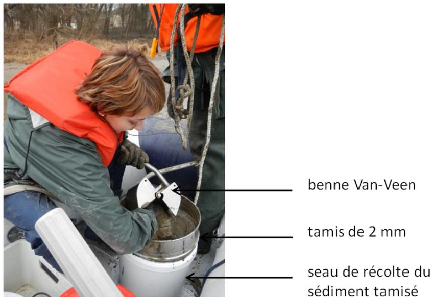
Figure 3: Prélèvement de sédiment et tamisage
